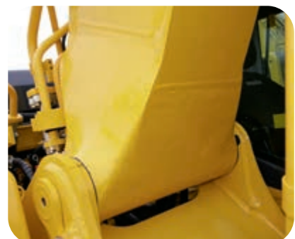
Støbt bomfod og bomplader i ét stykke
