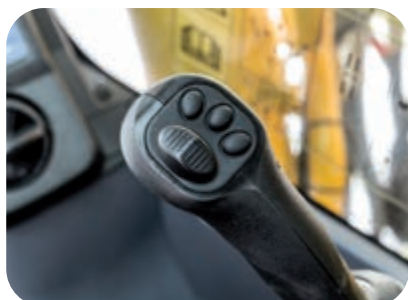
Praktisk, ergonomisk og præcis styring: joysticks med knap til proportionalstyring af redskaberne
